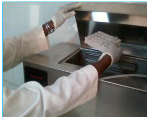
Photo 9: Digestion du broyat au bain-marie (CREC 2012)
