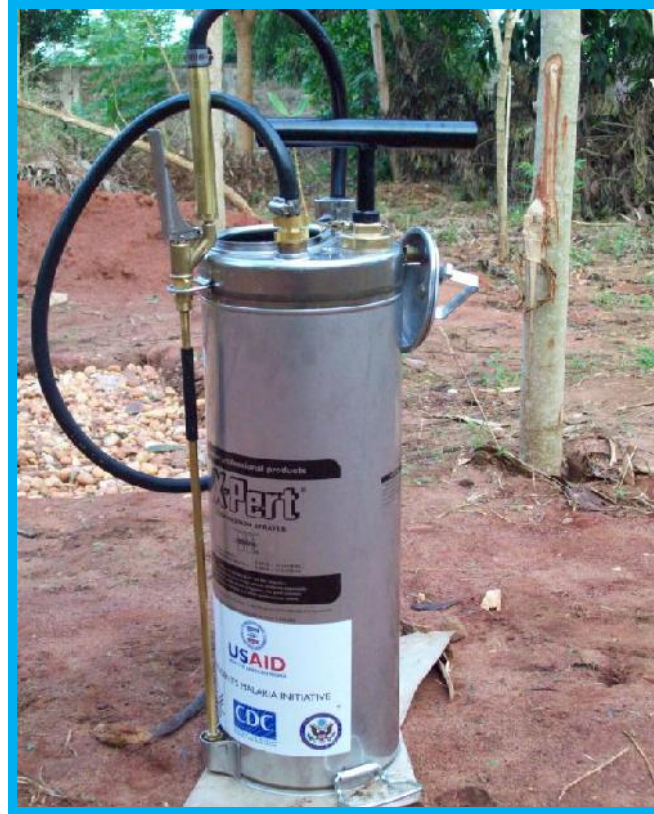
Figure 9 : Pulvérisateur manuel à pression préalable du type HUDSON XPERT
